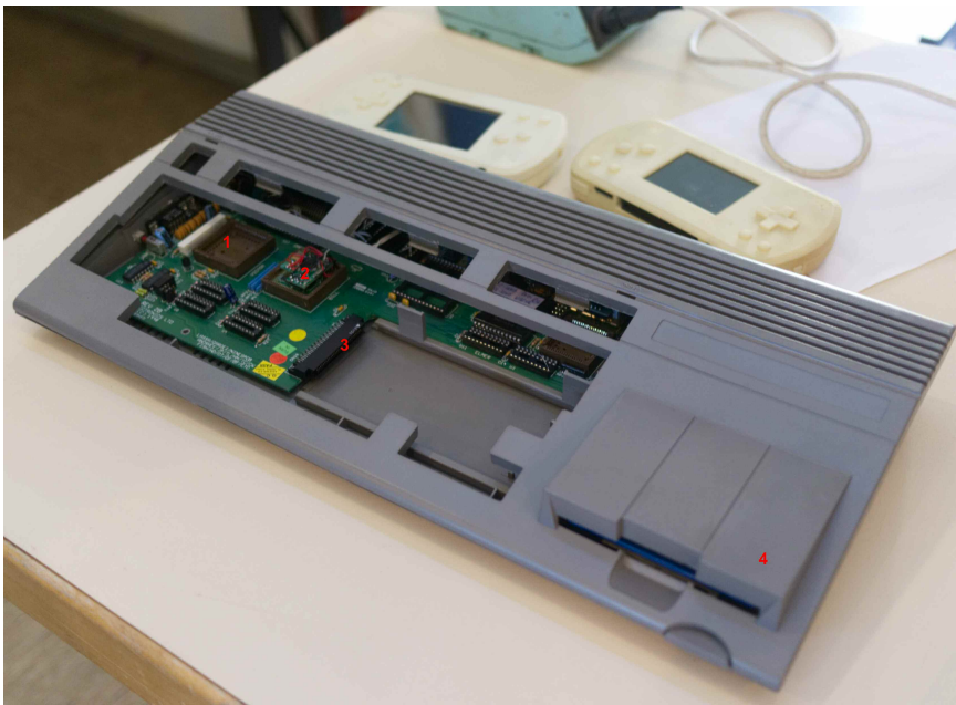
Das Gehäuse ist bis auf die Farbe eine exakte Replik des Originals. Im Inneren ist das nicht voll bestückte Motherboard zu sehen: (1) CSG 4510 CPU, (2) CSG 4567 VIC-III Grafikchip, (3) Slot für RAM-Erweiterung, (4) 3,5-Zoll-Laufwerk 880KB, 1581 kompatibel
