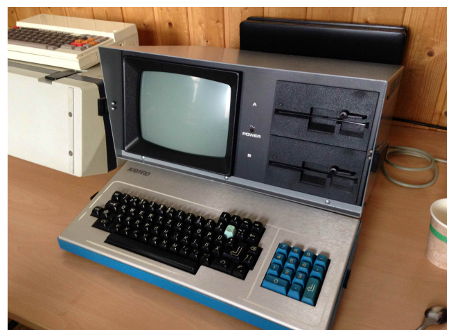
Heavy Metal: Das Gehäuse des Kaypro II (1982) ist komplett aus Metall gefertigt.
