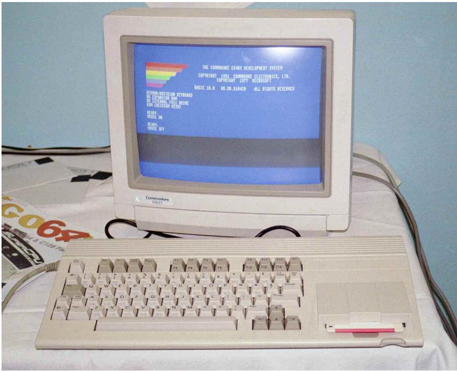
Ein funktionsfähiger C65 mit dem Basic 10.0 Prompt. Auffällig ist das vorderseitig angebrachte 3,5“-Laufwerk, ähnlich wie beim CPC6128 oder dem Schneider EuroPC.
