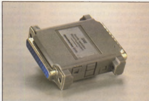
Das eigentliche SAM-Modul wird an den parallelen Port des ATARI ST gesteckt. Zur Stromversorgung muß jedoch noch ein weiteres Kabel an die MIDI-Schnittstelle angeschlossen werden.
