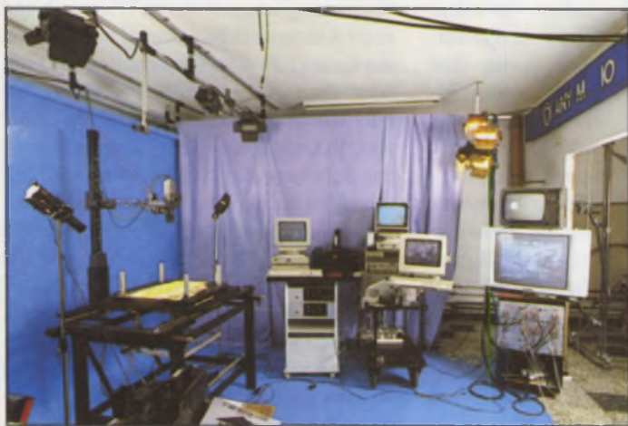
Teilansicht des Aufbaus im Trickstudio (links der schrittmotor-gesteuerte Tricktisch)
