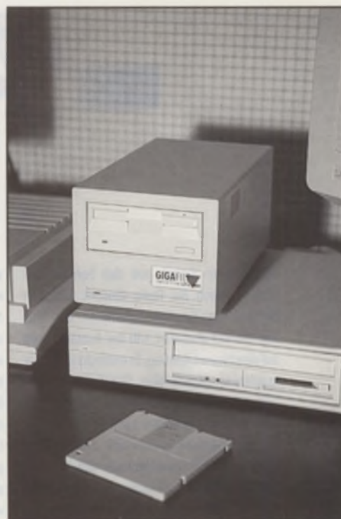
GIGAFILE128: 3,5"-Technik für 128 MB Speicherplatz im Vergleich zur herkömmlichen Wechselplatte
