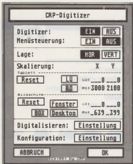
Der CRP-Digitizer mit DynaCADD-Menüfolie
