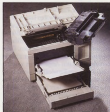
Der Klotz zeigt sein Innenleben. Herausgenommen: Die Toner-Belichtungseinheit oben rechts
